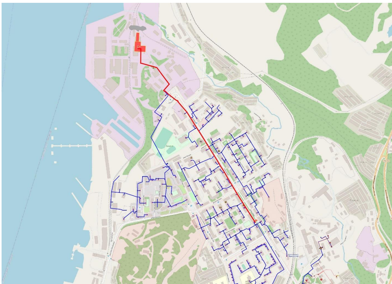
Рисунок 8 – Схема прокладки магистрального вывода потребителям котельной РОСТА
